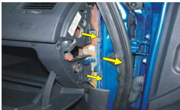
(PL) Usunąć uszczelkę gumową. Odkręcić wkręt mocujący element tapicerki, wyciągnąć tapicerkę
