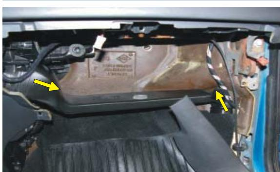
(PL) Zdemontować element kolektora wylotowego wentylacji, usunąć kolektor
